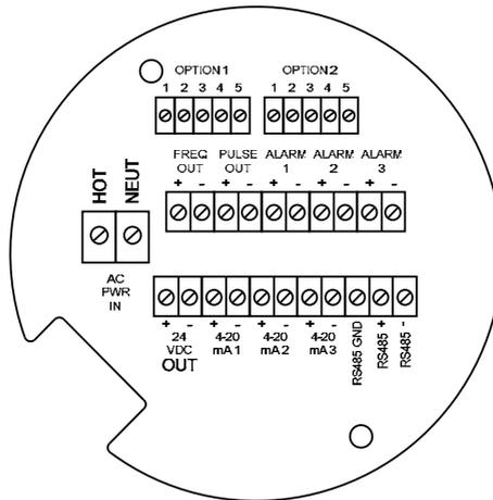
Fig. 23 ac wiring terminals
