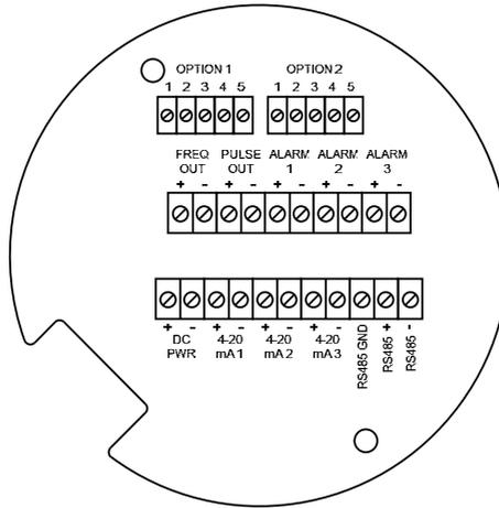
Fig. 25 dc wiring terminals
